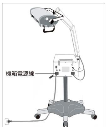
1. 將手臂下端兩條電源線插入控制箱後方的輸出插座。
