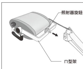
2. 將照射器旋鈕穿過照射器的U型架中孔。
