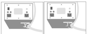
3. 可將手臂電源線從電線固定座缺口放入並扣緊，避免電線晃動。
